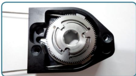
9. Achten Sie auf korrekten Sitz der Schalttrommel und deren Zentrierung in der Bohrung des inneren Ausspurblechs. Achten Sie insbesondere darauf keine Teile wie etwa die Ausspurnase des inneren Ausspurblechs durch unsachgemäße Handhabung zu verbiegen.
