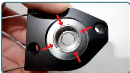
10. Drehen Sie den Deckel um die Halteschraube, so dass das äußere Ausspurblech frei sichtbar ist. Setzen Sie das äußere Ausspurblech auf das Gehäuse. Achten Sie darauf, dass das äußere Ausspurblech eben auf dem Gehäuse aufliegt und der Zentrierbund der Schalttrommel in der Bohrung des äußeren Ausspurblechs sitzt. Achten Sie darauf keine Teile wie etwa die Ausspurnase des äußeren Ausspurblechs durch unsachgemäße Handhabung zu verbiegen.
